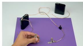
Paso 3: Conectar una segunda pila al circuito y reconectar.
