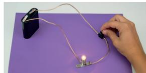
Paso 2: Desconectar el alambre entre la bombilla y la pila. Añadir otra bombilla entre estos dos componentes y volver a conectar el circuito.
